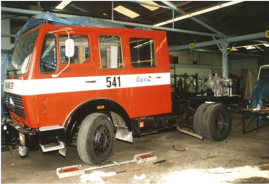
13.17 De 541 tijdens de renovatie. Alleen het chassis, de cabine en pomp zijn overgebleven.
