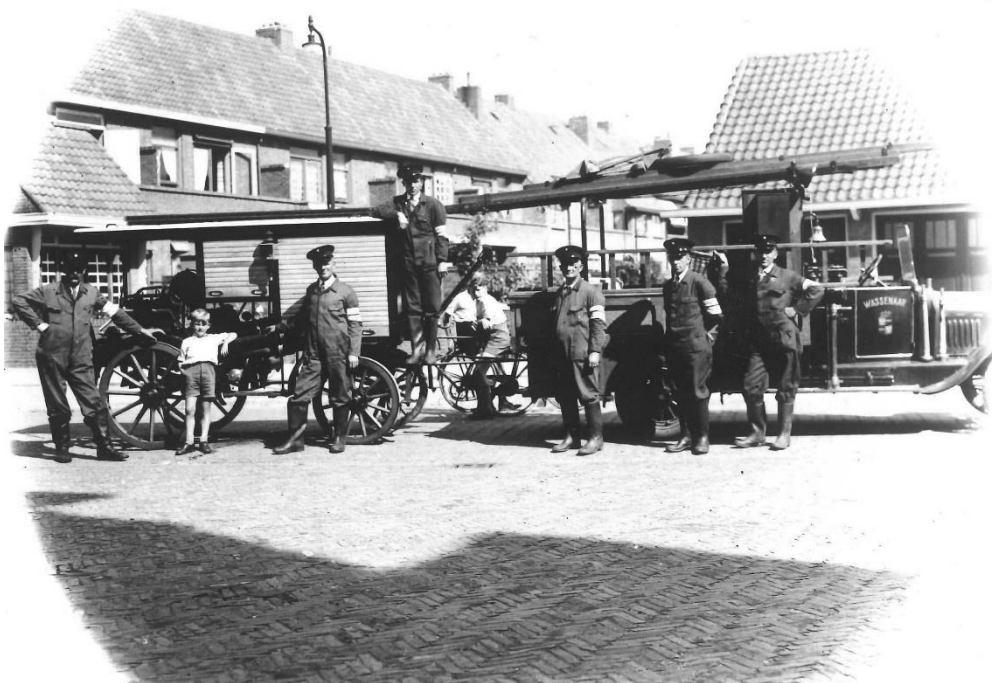
10.8 De polderspuit uit 1920 werd in de oorlogsjaren voorzien van een kasten-opbouw. De foto is uit 1941.
