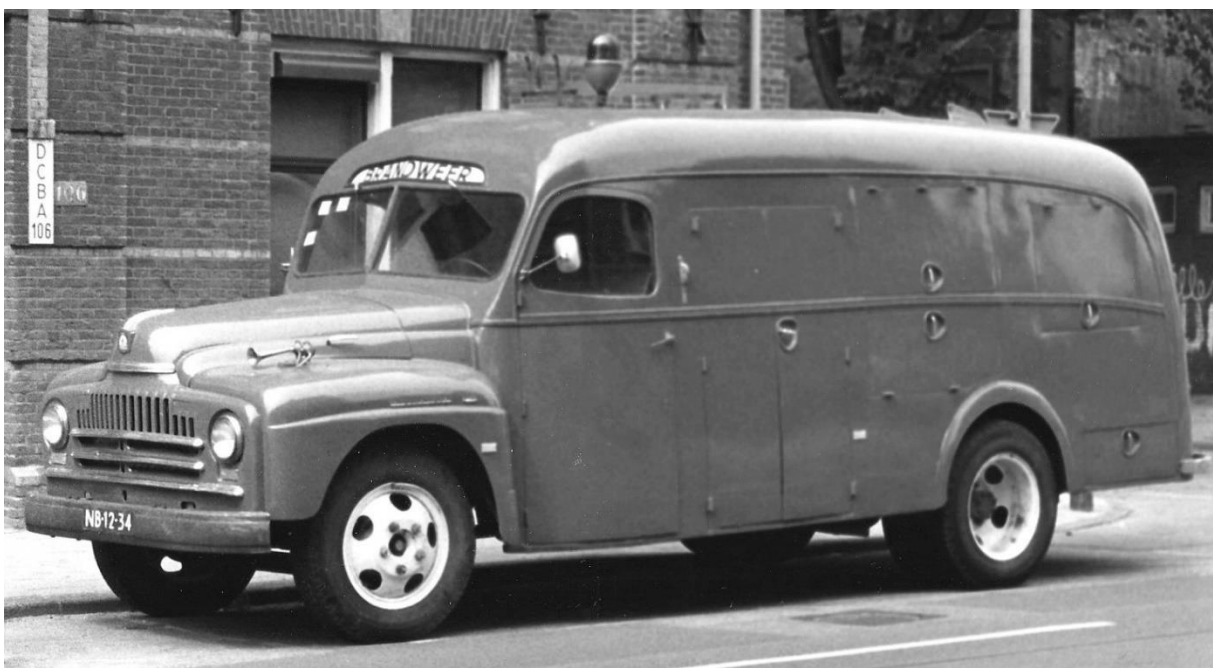
13.8 en 13.9 Mistspuit 1 uit 1951 was de eerste hogedruk tankautospuit van Wasseenaar. Het voertuig was opgebouwd op een International chassis door carrosseriebedrijf Boudewijn & Zn uit Geldermalsen. De aanschaf van deze auto kon eind 1951 op veel media-aandacht rekenen: 'De mistbrandspuit komt'. Dit had te maken met de nieuwe techniek om water onder hoge druk te kunnen spuiten (mist), maar ook een ingebouwde watertank (in dit geval 2000 liter) was iets nieuws in die tijd. Blussen van brand werd effectiever door de hoge druk en er kon veel sneller aangevangen worden met de bluswerkzaamheden vanwege de watertank. Het voertuig heeft dienst gedaan tot 1974. Linksboven in originele uitvoering. Onderstaand niet meer origineel.
