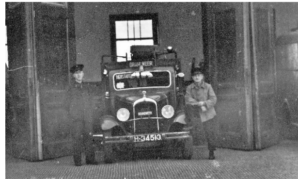
13.8 en 13.9 Mistspuit 1 uit 1951 was de eerste hogedruk tankautospuit van Wasseenaar. Het voertuig was opgebouwd op een International chassis door carrosseriebedrijf Boudewijn & Zn uit Geldermalsen. De aanschaf van deze auto kon eind 1951 op veel media-aandacht rekenen: 'De mistbrandspuit komt'. Dit had te maken met de nieuwe techniek om water onder hoge druk te kunnen spuiten (mist), maar ook een ingebouwde watertank (in dit geval 2000 liter) was iets nieuws in die tijd. Blussen van brand werd effectiever door de hoge druk en er kon veel sneller aangevangen worden met de bluswerkzaamheden vanwege de watertank. Het voertuig heeft dienst gedaan tot 1974. Linksboven in originele uitvoering. Onderstaand niet meer origineel.
