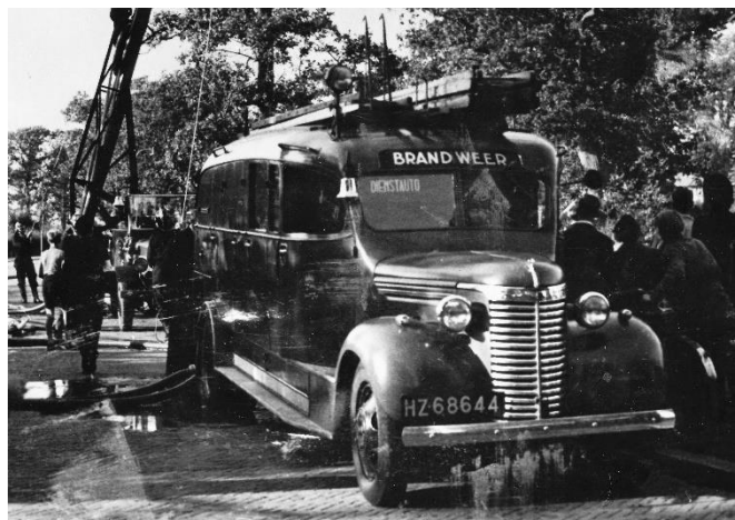
13.4 en 13.5 De Magirus autoladder welke in 1931 werd aangeschaft had een werkhogte van 16 meter. Op de rechterfoto is op de voorgrond de Chevrolet autospuit te zien. Dit voertuig met een opbouw van de firma Geesink had een pompcapaciteit van 2000 liter per minuut. Het voertuig was in 1941 gereed maar werd pas in 1943 afgeleverd. De foto is gemaakt bij een oefening in 1950.
