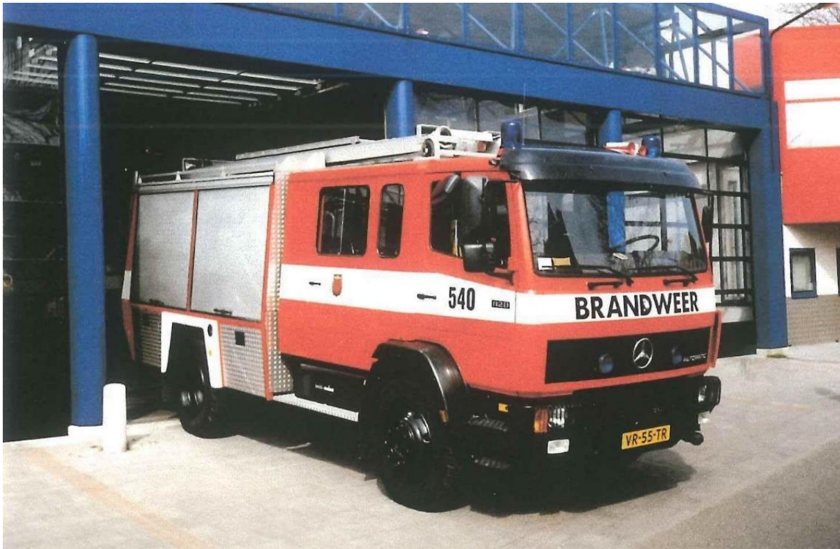
13.24 Wederom een nieuwe 540 werd afgeleverd in 1992. De tankautospuit is opgebouwd op een Mercedes 1120AF chassis en een Doeschot Rosenbauer opbouw. Dit was het eerste terreinvaardige blusvoertuig in Wassenaar. In een gemeente met duizenden hectares bos- en duingebied geen overbodige luxe. Dit werd pijnlijk duidelijk bij een grote duinbrand op 26 juli 1990. Een onverhard pad waarover de voertuigen reden werd tijdens de brand zo slecht, dat meerdere voertuigen vast kwamen te zitten.
