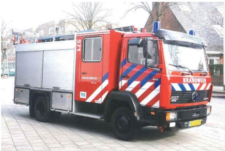
13.25 Het hulpverleningsvoertuig 571 werd in 1990 in gebruik genomen en bood plaats aan 6 personen. Dit was een zogenaamde HV2 en werd gebruikt bij technische hulpverleningen en kon ook gebruikt worden voor personenvervoer bij grote incidenten. Het chassis was een Mercedes 914F en de opbouw was verzorgd door Saval Kronenburg met een kantelcabine. Na de regionalisering in 2010 werd het voertuig in 2011 vervangen.
