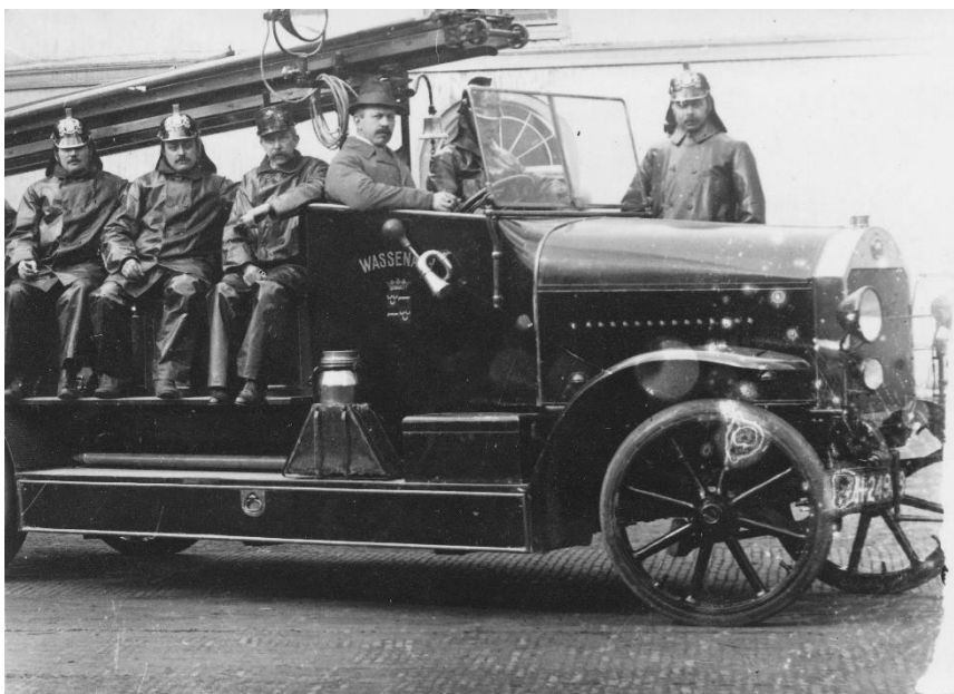
13.2 In 1921 werd de eerste autospuit aangekocht met een pompcapaciteit van 1500 liter per minuut. Het fabricaat was Magirus en de opbouw werd gerealiseerd bij de firma Geesink.
