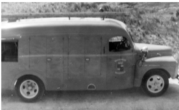
13.8 en 13.9 Mistspuit 1 uit 1951 was de eerste hogedruk tankautospuit van Wasseenaar. Het voertuig was opgebouwd op een International chassis door carrosseriebedrijf Boudewijn & Zn uit Geldermalsen. De aanschaf van deze auto kon eind 1951 op veel media-aandacht rekenen: 'De mistbrandspuit komt'. Dit had te maken met de nieuwe techniek om water onder hoge druk te kunnen spuiten (mist), maar ook een ingebouwde watertank (in dit geval 2000 liter) was iets nieuws in die tijd. Blussen van brand werd effectiever door de hoge druk en er kon veel sneller aangevangen worden met de bluswerkzaamheden vanwege de watertank. Het voertuig heeft dienst gedaan tot 1974. Linksboven in originele uitvoering. Onderstaand niet meer origineel.
